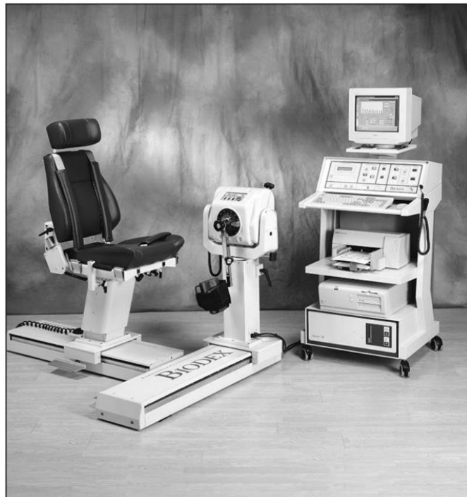
Figure 3. Appareil Biodex 3, incluant la chaise de positionnement, ses courroies et le dynamomètre, positionnés pour les mesures de flexion/extension du genou, ainsi que le panneau de contrôle (image tirée du manuel d'utilisation Biodex) 193
